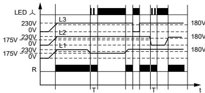
Если напряжение на всех фазах будет выше 175 V и перед этим не было ошибки, то наступит включение исполнительного реле R. Если напряжение на одной из трех фаз L1, L2, L3 упадет до значения 175 V, тогда после отсчета времени задержки 4 сек., контакт R будет выключен. Исполнительное реле R будет снова включено в момент, когда значение напряжения на данной фазе возрастет до 180 V. Резкий обрыв фазы рассматривается как ошибка чередования фаз и в таком случае не ведется отсчет времени задержки.
