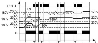
Исполнительное реле R переключается в выключенное положение, в случае, когда асимметрия превысит значение 55 V. Асимметрия, вызванная обратным напряжением нагрузки (например: электродвигателя, который продолжает работать на двух фазах) не приводит к отключению.
